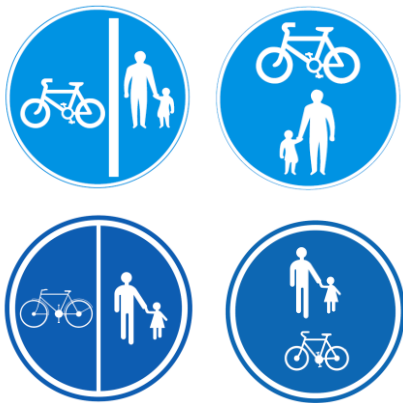
Дорожные знаки для смежных и совмещенных велопешеходных дорожек (сверху знаки, используемые в Великобритании, снизу – в Бельгии)
