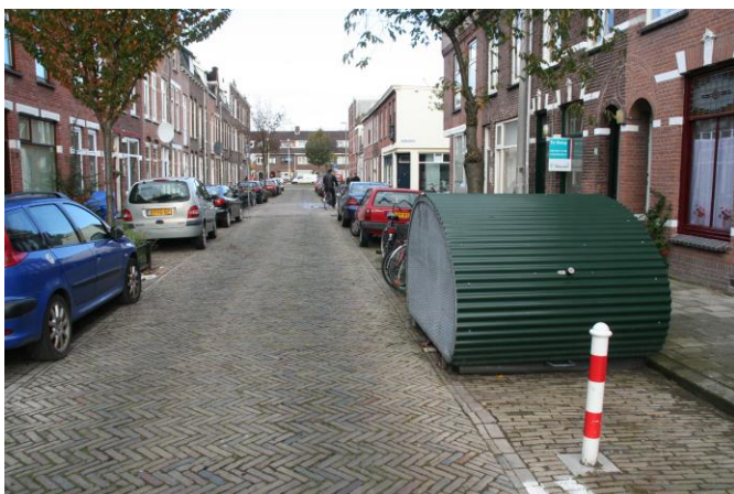
Велогараж-ракушка, установленный на парковочной полосе улицы в жилом районе. Столбик препятствует парковке автомобилей там, где они мешали бы доступу к гаражу. Утрехт, Нидерланды 2
