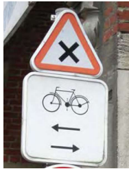
Shenjë alarmuese e pedalimit kundër-rrjedhë në anë të rrugës, Bruksel, BE (D. Dufour)
