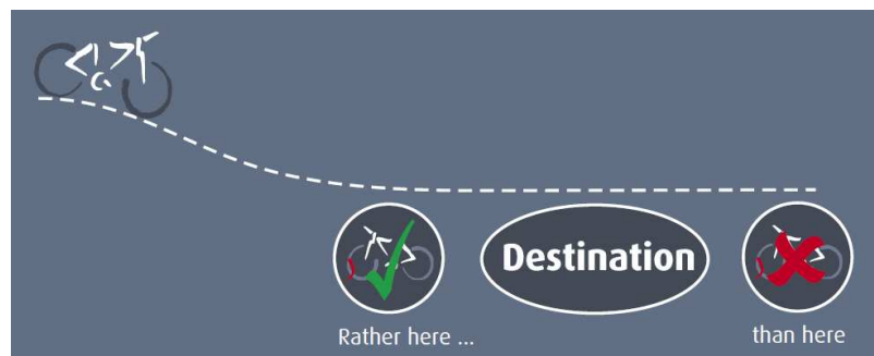
Parken am natürlichen Zugangsweg (Quelle: DCF, 2008 Bicycle Parking Manual (Handbuch für Fahrradabstellplätze), DK)
