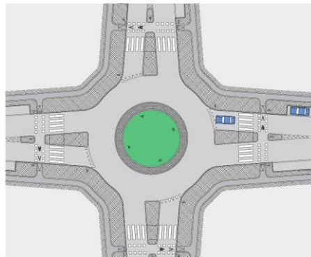
Carrefour giratoire avec voie unique, piste cyclable et sans priorité donnée aux cyclistes. Notez la conception plus angulaire.
