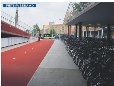
Велосипедна станція на пересадочному транспортному вузлі в Гронінгені (Нідерланди). Знаходиться під землею, має добре природнє освітлення та похилу рампу для зручного заїзду (Фото: Fietsberaad – NL)
