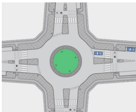
Однополосный кольцевой перекрёсток с обособленной велодорожкой, не имеющей приоритета. Трассировка велодорожки более угловатая.
