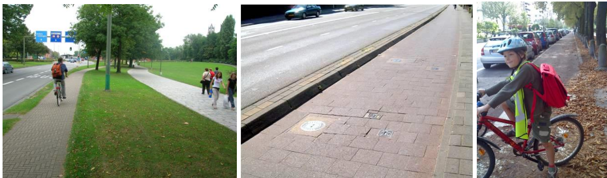
Велосипедные дорожки с различными способами обособления от проезжей части: полоска газона, приподнятый бордюр и парковочная полоса (фото: Т. Aspergers, Р. Kroeze, D. Dufour)
