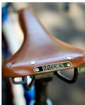
**Sella:** le selle in gel sono oggi molto diffuse. Il gel viene applicato industrialmente sotto la superficie della sella allo scopo di distribuire il peso del ciclista in maniera ottimale. Le selle in cuoio stanno tornando in auge. Hanno il vantaggio di adattarsi, dopo qualche tempo, alla particolare forma anatomica dell'utilizzatore. Inoltre sono porose e permettono la traspirazione. D'altro canto, richiedono una certa manutenzione. Per mantenere la pelle elastica, vanno oliate regolarmente.
