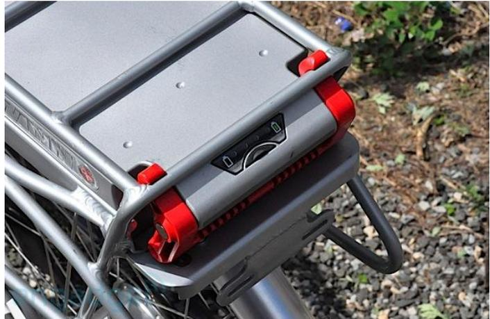
Quanta energia dovrebbe tenere una batteria per bici elettrica? Il ciclista "in forma" medio può pedalare con uno sforzo meccanico di 100 watt a 15 km/h. Quindi se uno volesse viaggiare 2 ore con l'apporto della sola batteria avrebbe bisogno di un'energia pari a 200 watt-ora per mantenere i 15 km/h di velocità con il sistema batteria-motore. In effetti ne servirà di più per far fronte alle inevitabili perdite di energia del sistema.
