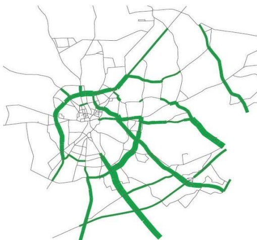
Малюнок 10: Зниження обсягів перевезень (моторизований транспорт) у дорожній мережі, пов'язане зі сценарієм "Оновлення велосипедних об'єктів згідно з нормативами технічного проектування" (Результат VISUM-моделювання; відображаються обсяги трафіку >1,000 авто/день, пілотне-місто: Гютерсло. Джерело: Звіт BAST V 227)
