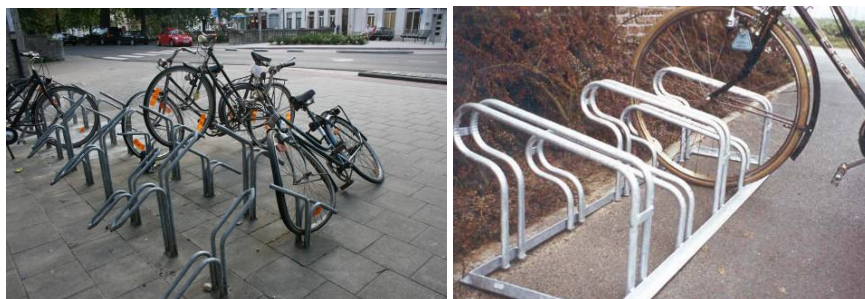
NALEŻY UNIKAĆ STOSOWANIA poziomych stojaków do mocowania przedniego koła (źródło: T. Asperges)
