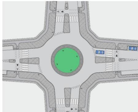
Rotatoria a una corsia con pista ciclabile in sede propria senza diritto di precedenza per i ciclisti. Da notare la forma più spigolosa.
