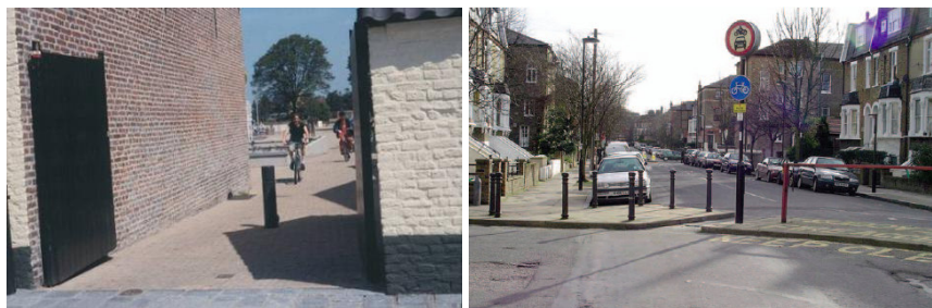
Zamknięcie wylotu ulicy przy pomocy pachołka lub by-passu dla rowerów (źródło zdjęć: T. Asperges)
