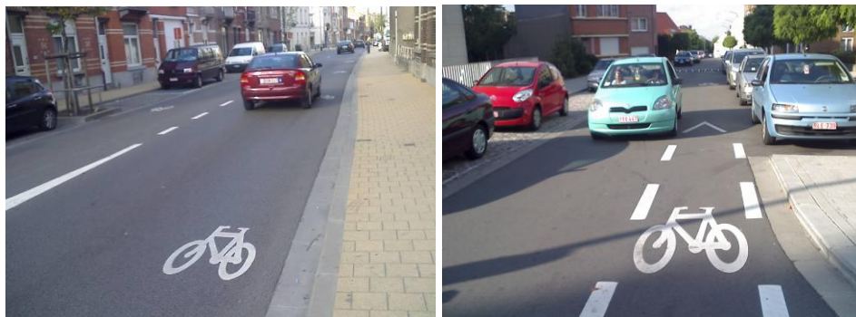
Bande multi-usage et double-sens cyclable sans marquage (crédit photo : D. Dufour)
